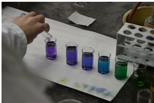
Obr. 3 Overenie pH stupnica s dostupnými ukazovateľmi - extrakt z červenej kapusty (foto: Šponiar)
