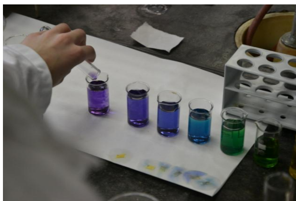
Pic. 3 Verificação da escala de pH com indicadores disponíveis - extrato de repolho roxo (foto: Šponiar)
