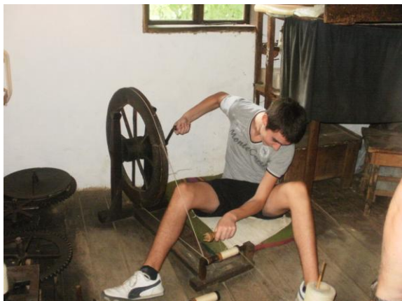
Obr.1. Navíjanie priadze na cievkach pomocou rotujúceho kolesa ("chekrak")
