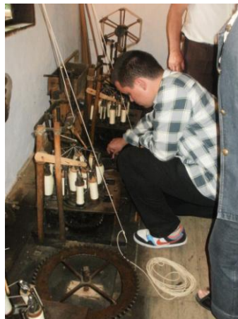
Obr.2. Pletenie "Gaytan" s pomocou špeciálneho mechanizmu ozubnicovej koleso s názvom "Chark"
