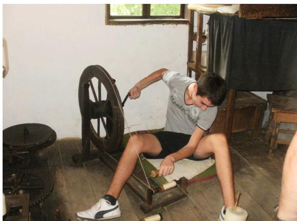
Fig.1. Avvolgimento del filato sulle bobine con l'aiuto di un filatoio ("chekrak")
