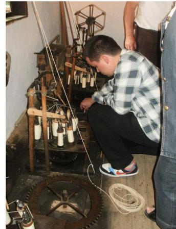
Fig.2. Tricot "Gaytan" avec l'aide d'un mécanisme de roue dentée spéciale appelée «chark»
