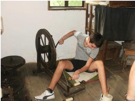
Fig.1. Enrouler le fil sur les bobines à l'aide d'une roue de rotation ("chekrak")
