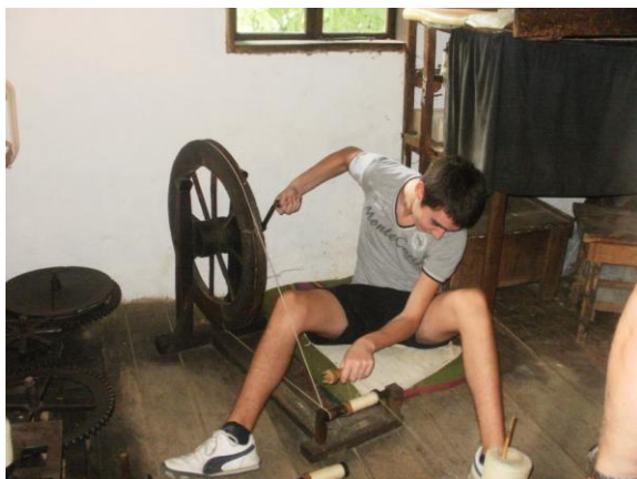
Σχ.1. Περιέλιξη του νήματος επί των καρουλιών, με τη βοήθεια ενός περιστρεφόμενου τροχού ("chekrak")
