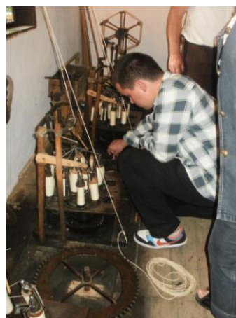
Σχ.2. Πλέξιμο "gaytan" με τη βοήθεια ενός ειδικού μηχανισμού οδοντωτού τροχού που ονομάζεται "Chark"
