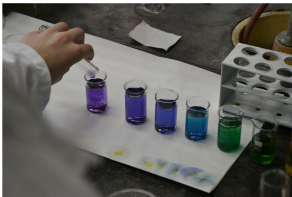
Pic. 3 Επαλήθευση της κλίμακας του pH με διαθέσιμους δείκτες - εκχύλισμα του κόκκινου λάχανου (foto: Šroniar)
