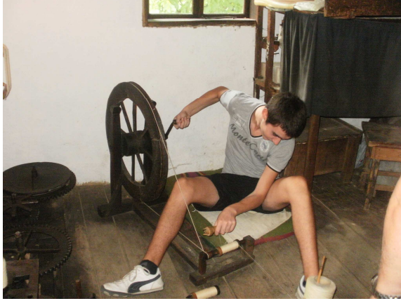
Şekil.1. ("Chekrak") bir çıkıkrık yardımıyla makaralar üzerinde iplik sargı
