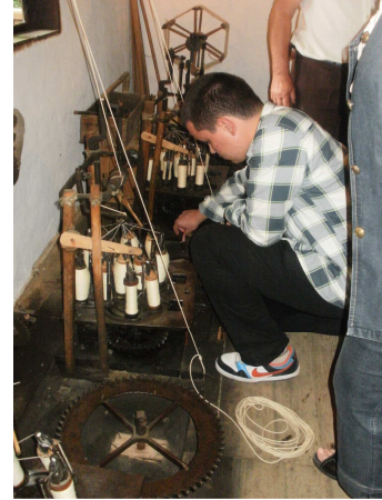
Şekil.2. Bir "Chark" denilen özel bir dişli tekerlek mekanizması yardımıyla "Gaytán" Örgü
