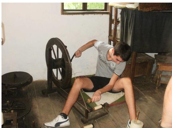
Fig.1. Enrolamento fazer fio sobre como Bobinas com a Ajuda de UMA roda de Fiação ("chekrak")
