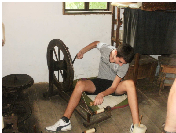
Rys.1. Nawijanie przędzy na szpule pomocą wirującej tarczy ("chekrak")
