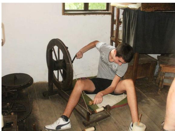
Fig.1. Enrollar el hilo sobre las bobinas con la ayuda de una rueda giratoria ("chekrak")
