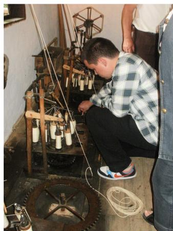
Fig.2. Knitting "gaytan" con la ayuda de un mecanismo de rueda dentada especial llamado "Chark"
