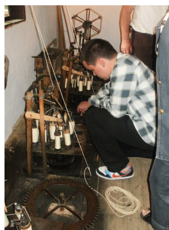
Фиг.2. Плетене "Гайтан" с помощта на специален механизъм за зъбно колело, наречено "чарк"
