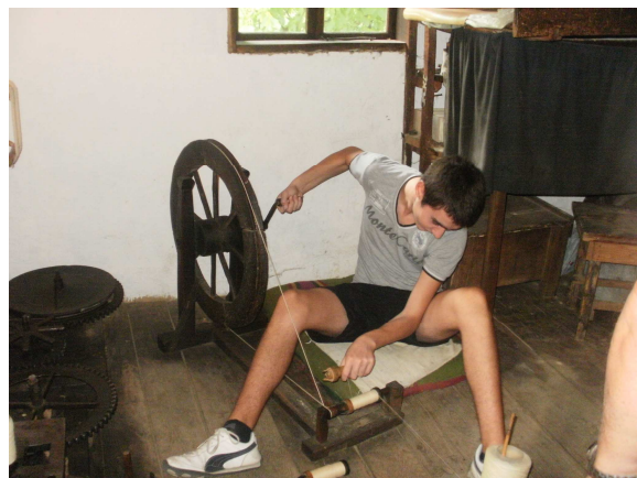
Фиг.1. Навиване на прежда на ролки с помощта на чекрък ("chekrak")
