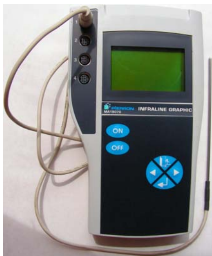
3 Přístroj Infraline Graphic R s připojeným teplotním čidlem
